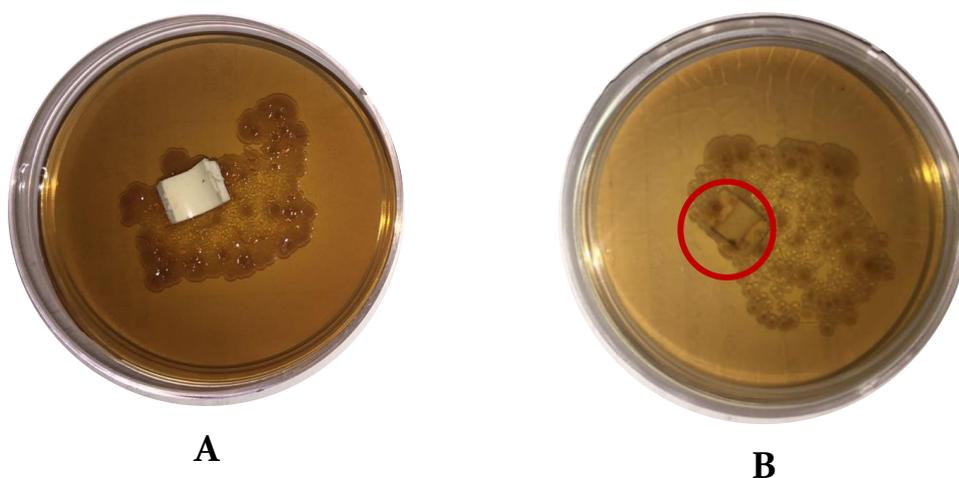
**Figura 10.** Crecimiento de *E.Coli* en agar bilis y rojo de violeta utilizando un cupón de PVC colocado en la superficie. A) vista superior y B) vista inferior
