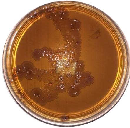
**Figura 13.** Crecimiento de E.Coli en agar bilis y rojo de violeta utilizando un cupón de CPVC inundado completamente.
