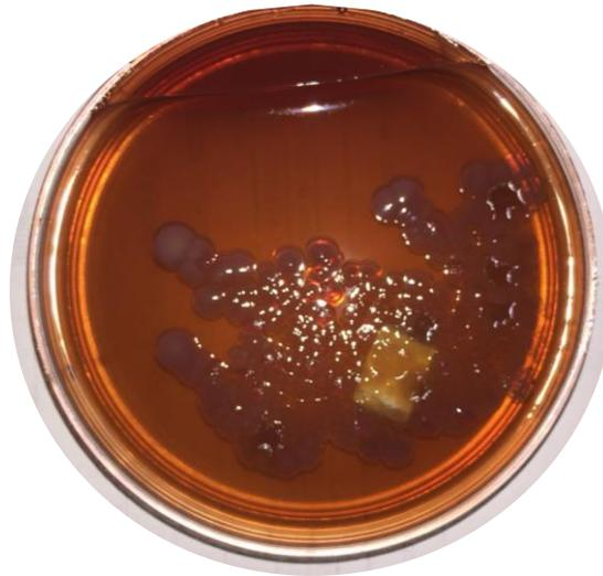
**Figura 15.** Crecimiento de E.Coli en agar bilis y rojo de violeta utilizando un cupón de PPR inundado completamente.
